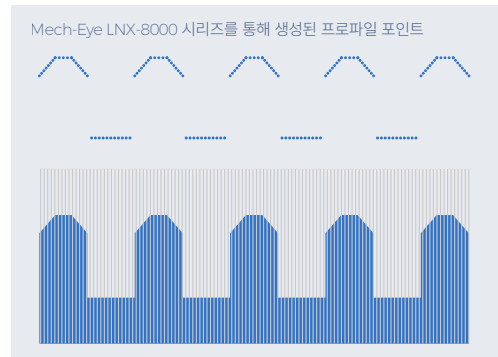
X축 스캔 범위가 동일한 경우, LNX 8000 시리즈는 기타 라인 프로파일러보다 더 많은 프로파일 포인트를 생성할 수 있습니다.
