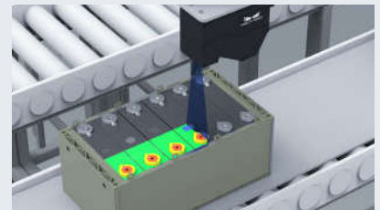
리튬 배터리 모듈 busbar 용접 검사
