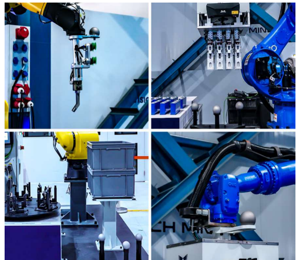
다양한 공정에 사용되는 시스템 드리프트 자동 보정 도구
