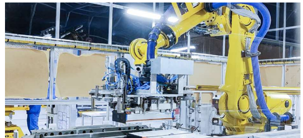
비전 가이드 배터리 모듈의 머신 텐딩
