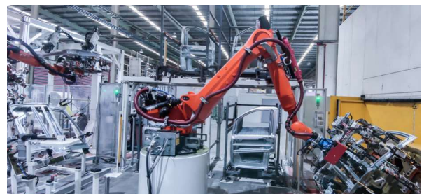
비전 가이드 자동차 도어 내부 패널 피킹
