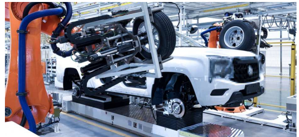
비전 가이드 휠 설치
