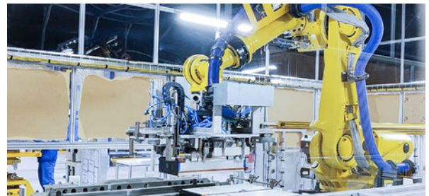
비전 가이드 배터리 모듈의 머신 텐딩
