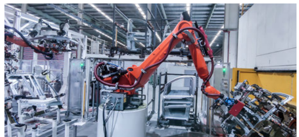
비전 가이드 자동차 도어 내부 패널 피킹
