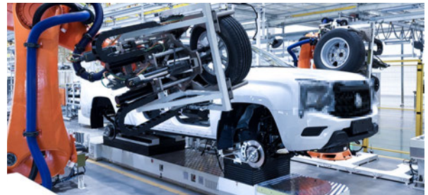
비전 가이드 휠 설치
